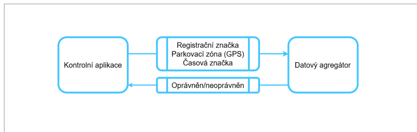
Obrázek 19 – Diagram datové komunikace mezi kontrolní aplikací a datovým agregátorem
